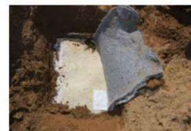
Csse2試験後（保護シート2枚）
