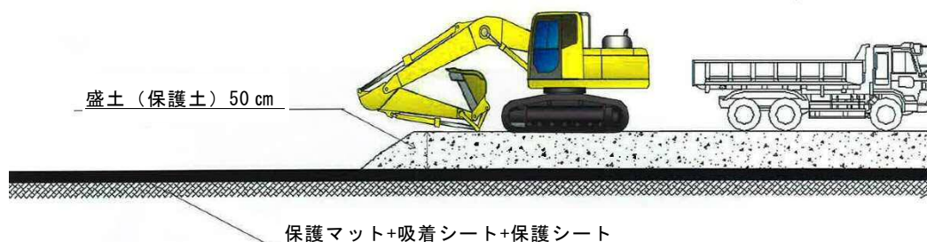
図-10 重機走行試験概要
